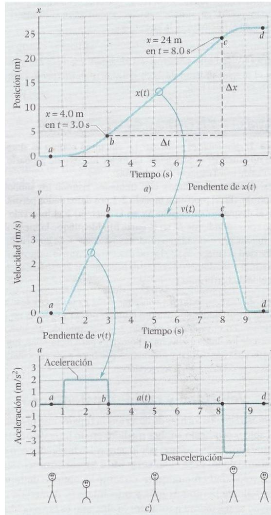
ILUSTRACIÓN 2-7 a) Curva  $x(t)$  para una cabina de elevador que se mueve hacia arriba a lo largo de un eje  $x$ . b) Curva  $v(t)$  para la cabina. Nótese que es la derivada de la curva  $x(t)$ , ( $v = dx/dt$ ). c) Curva  $a(t)$  para la cabina. Es la derivada de la curva  $v(t)$  ( $a = dv/dt$ ). Las figuras a lo largo de la parte inferior sugieren cómo se sentiría el cuerpo de un pasajero durante las aceleraciones (tomada de Halliday, Resnick y Walker, 2009, p. 18).
