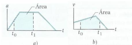
ILUSTRACIÓN 2-9 El área entre una curva trazada y el eje horizontal del tiempo, del tiempo  $t_0$  al tiempo  $t_1$ , está indicada para a) una gráfica de aceleración  $a$  contra  $t$  y b) una gráfica de velocidad  $v$  contra  $t$  (tomada de [Halliday, Resnick y Walker, 2009, p. 27](#)).
