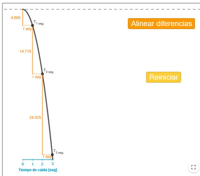
Al hacer clic en [Alinear diferencias], los segmentos de las diferencias se desplazan hacia la derecha y se alinean en sus extremos superiores:
