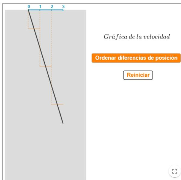
Al hacer clic en [Ordenar diferencias de posición], los segmentos correspondientes a las diferencias se desplazan hacia abajo, de tal manera que el extremo superior de cada uno se encuentre a la misma altura que el extremo inferior del que tiene a su izquierda; la gráfica pasa de ser un segmento de recta a ser un tramo de una parábola cóncava hacia abajo, asimismo, el texto cambia a “Gráfica de la posición”:
