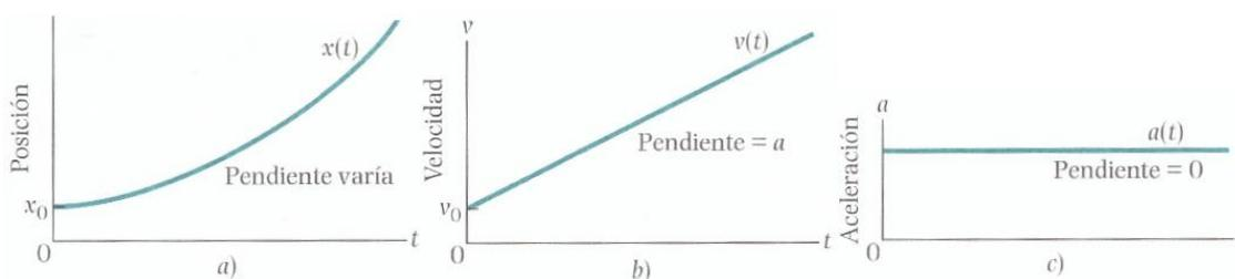
ILUSTRACIÓN 2-8 a) Posición  $x(t)$  de una partícula que se mueve con aceleración constante. b) Su velocidad  $v(t)$ , dada en cada punto por la pendiente de la curva en a). c) Su aceleración (constante). Igual a la pendiente (constante) de la curva  $v(t)$  (tomada de Halliday, Resnick y Walker, 2009, p. 21).
