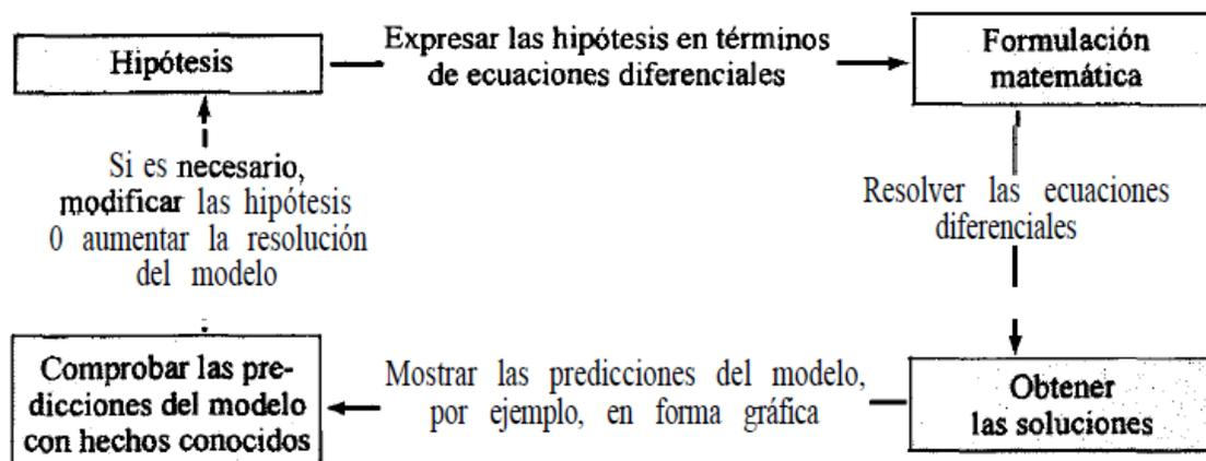
ILUSTRACIÓN 2-3 Pasos del proceso de modelado según Zill (1997, p. 20).
