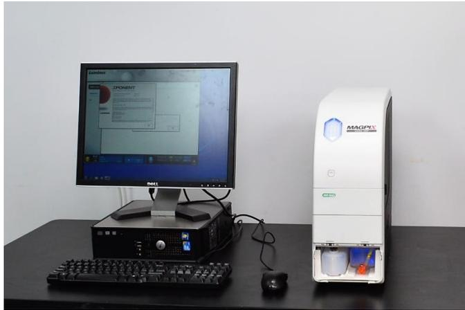
Figura 11. Analizador LuminexMagpix.
