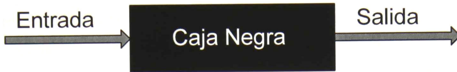
Figura 1.5: Pruebas de caja negra. Las pruebas de caja negra se enfocan en probar las especificaciones del software.
