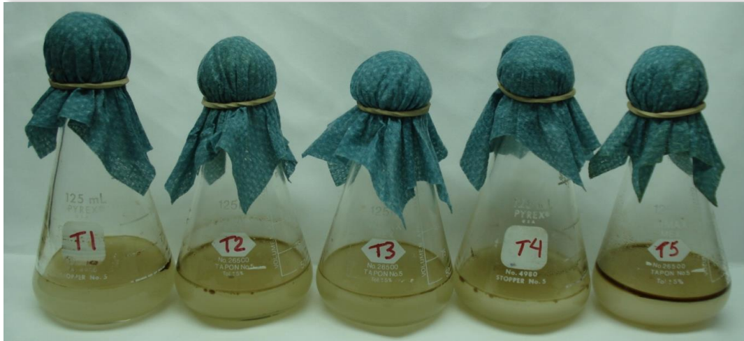
Figura 19. Degradación de petróleo crudo por microorganismos asociados al grano de café inmovilizados en fibras vegetales a las 3 semanas de incubación.
