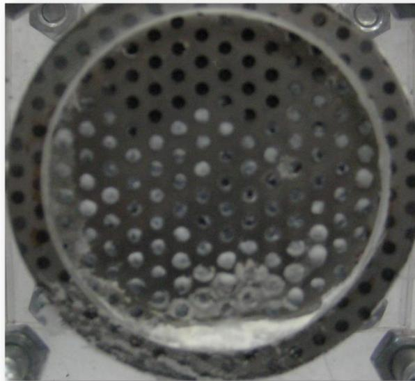
**Figura 27. Depósitos de sales en la parte externa del cátodo de la CCM equipada con NF-117, bservados a partir del día 11 de operación en lote.**
