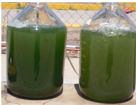
Figura 22. Fotobiorreactor tipo columna de burbujas de 10 L de capacidad a la intemperie (día 28)
