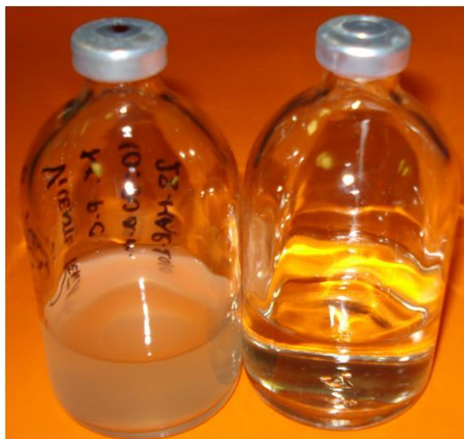
Figura 2.13: Cambio de color del medio de cultivo Postgate C, después de inocular las botellas con 5 mL de inóculo.
