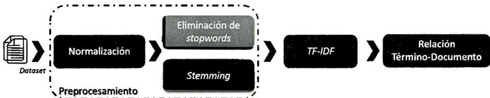
Figura 4.19: Esquema del módulo de representación de documentos.
