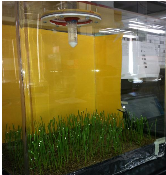
Figura 4. Cámara de enriquecimiento con ^{13}\text{C} de plantas mediante la técnica ^{13}\text{CO}_2 pulse-labelling ' (Fuente: Ruíz-Valdiviezo et al. , 2012 en proceso ).
