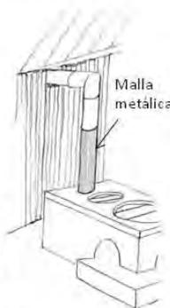
1. Una vez colocada la tapa, unir el codo y el tubo galvanizado, dirigiéndolos hacia afuera de la casa, por afuera del volado del techo.
