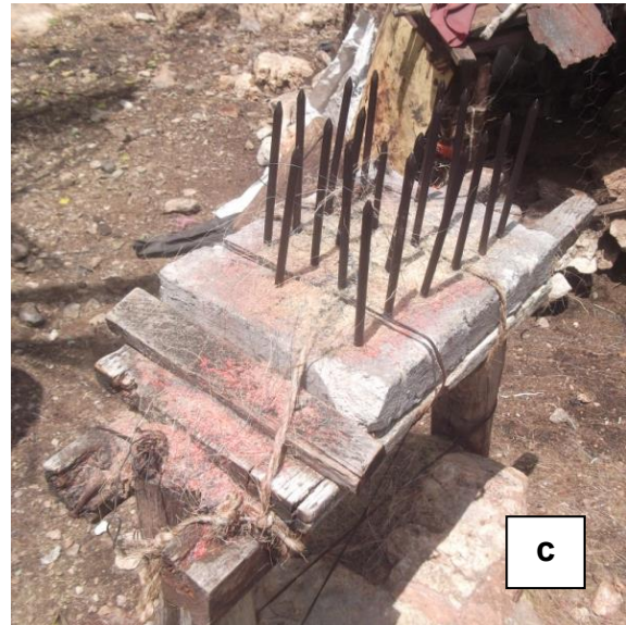
Figura 7: Ejemplo de peines caseros para henequén:(a) peine de banco (b) peine de mesa c) peine de cemento, fotos propias
