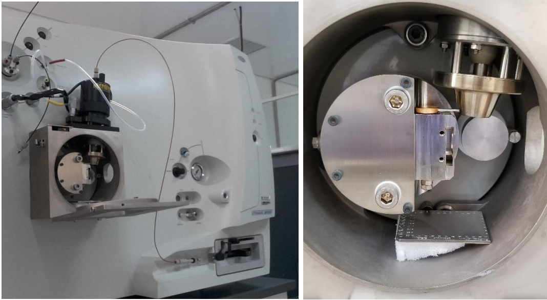
Anexo 1. Fotografía del método de deposición de matriz con “microspray”. A) muestra el equipo LCT de Waters, UK. B) Es un acercamiento a la fuente de ionización utilizada como aspersor de matriz sobre una placa de MALDI.
