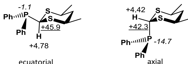
Figura 3.19. RMN de 31 P, 1 H y 13 C en C2 para los conformeros de la (4,6-dimetil-[1,3]-ditian-2-il)-difenilfosfina. 134
