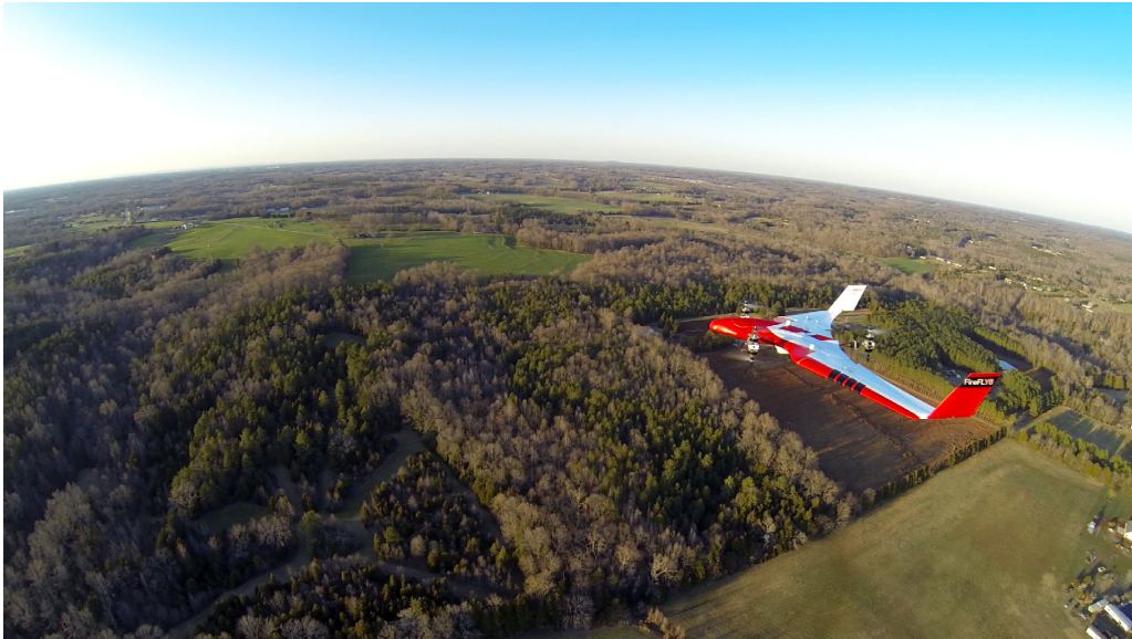
Figura 1.3: Helicóptero en configuración Y6 convertible en avión
