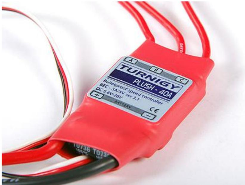
Figura 2.4: ESC Turnigy PLUSH 40A
