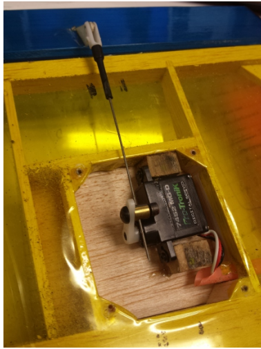
Figura 2.5: Colocación del servo para el control del alerón.
