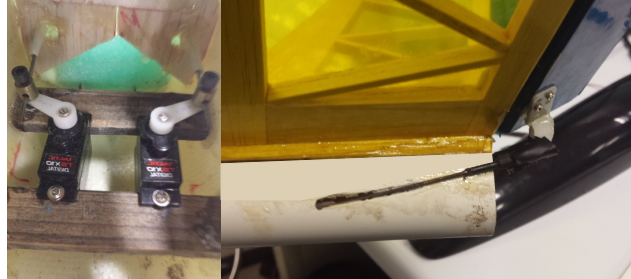
Figura 2.6: Colocación del servo para el control del rudervator.
