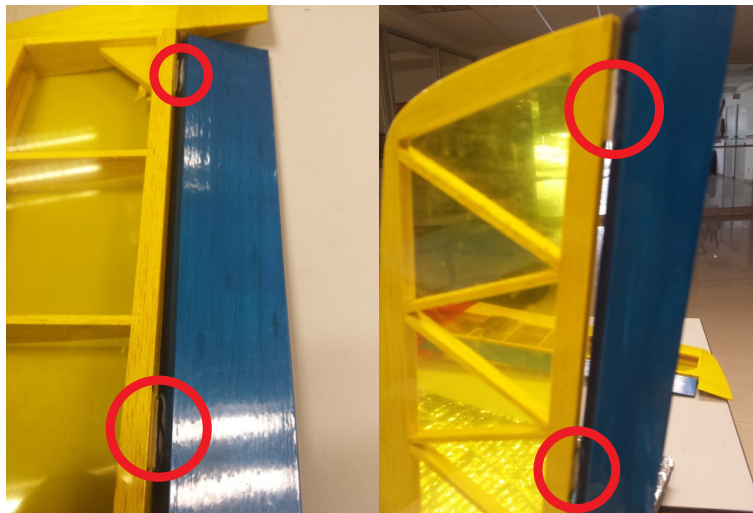
Figura 2.4: Colocación de bisagras en el alerón del lado derecho y rudervator del lado izquierdo.
