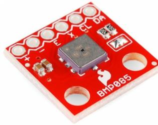
FIGURA 5.21: Sensor de presión BMP085.
