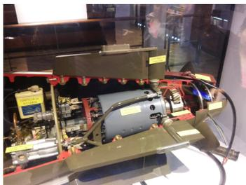
(D) Propulsión del torpedo.
