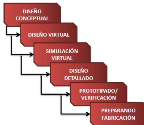
FIGURA 5.1: Proceso empleado para el diseño del AUV.
