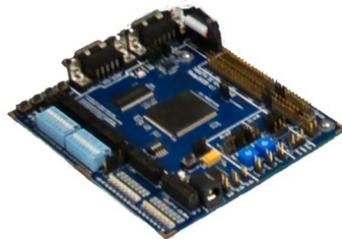
FIGURA 5.17: Procesador digital de señales ONIK.
