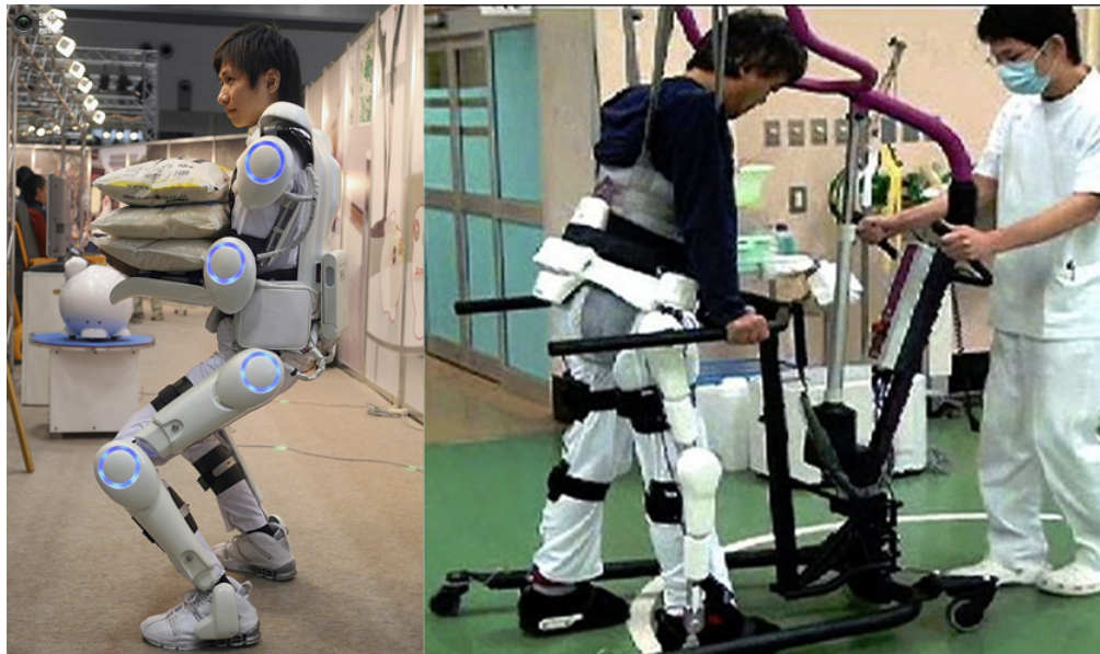
Figura 1.4: Prototipo Japones para rehabilitación de extremidades inferiores y asistencia de cuerpo completo.
