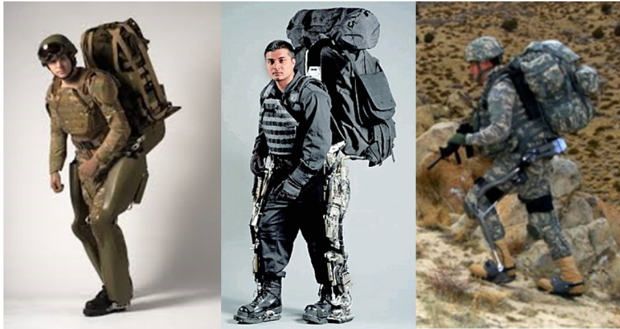
Figura 1.3: Prototipo Berkeley Lower Extremity Exoskeleton(BLEEX) de la Universidad de California de Berkeley.
