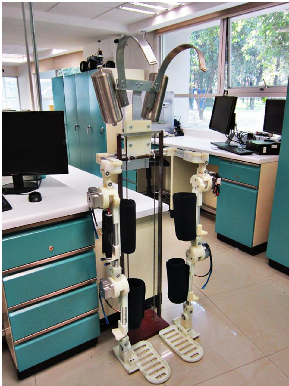
Figura 6.2: Construcción de Exoesqueleto híbrido con 6 DOF.
