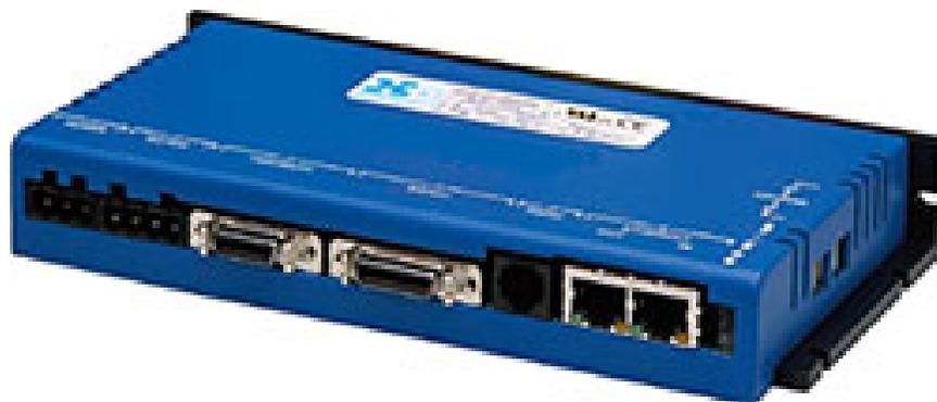
Figura 6.4: Driver para motor Harmonic-Drive.
