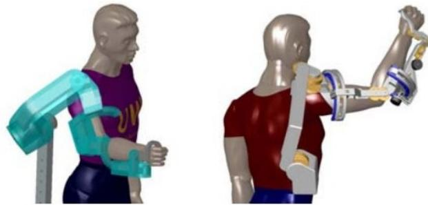
Figura 2.2: El exoesqueleto de la Universidad de Washington en CAD.
