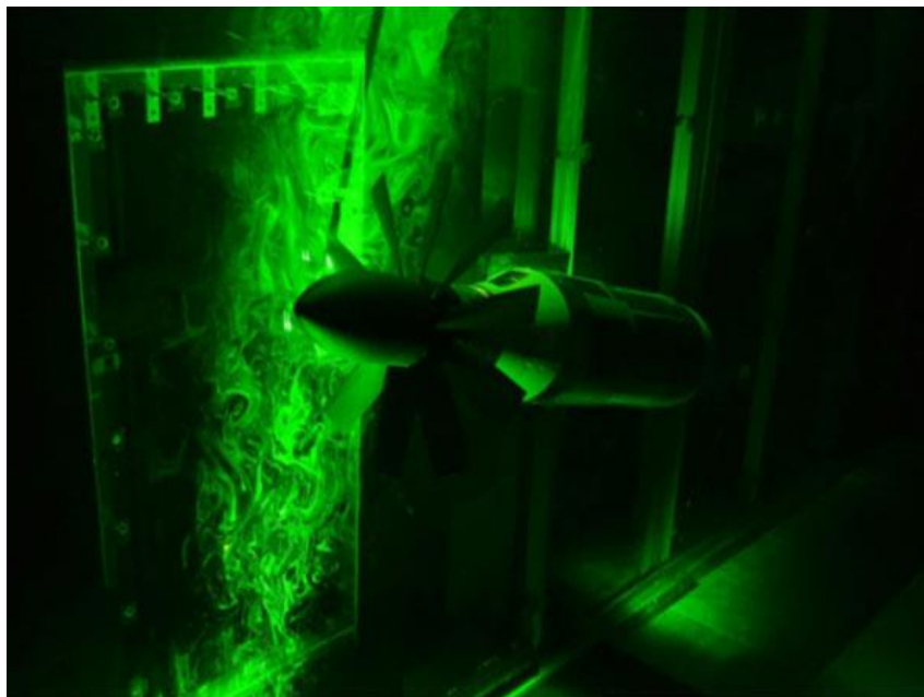
Figura B.1: Sección del Túnel de Viento con un banco de pruebas instalado.
