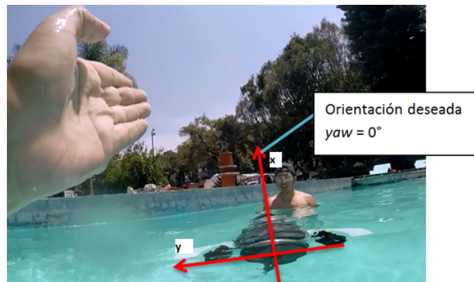
FIGURA 6.13: AUV con una orientación de yaw a cero grados
