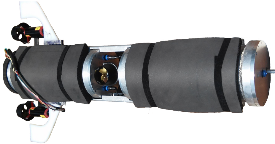
FIGURA 6.4: AUV Sx-1013 completo y funcional.
