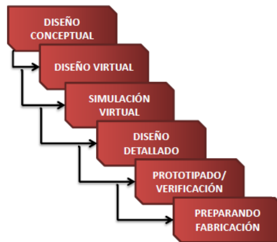
FIGURA 5.1: Proceso empleado para el diseño del AUV.
