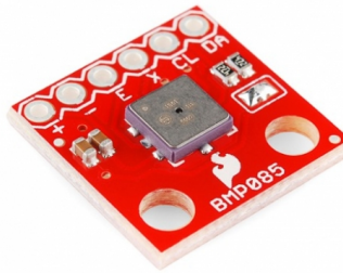
FIGURA 5.21: Sensor de presión BMP085.
