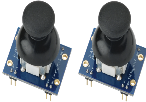
Figura 5.2: Módulo Joystick 2 ejes XY.
