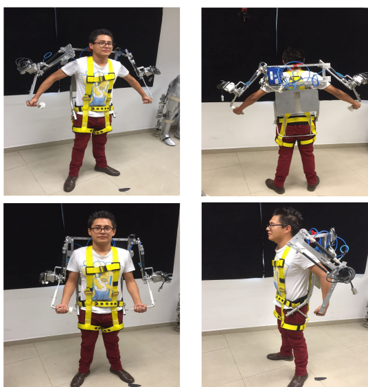
Figura 4.12: Movimientos en los miembros superiores del exoesqueleto.
