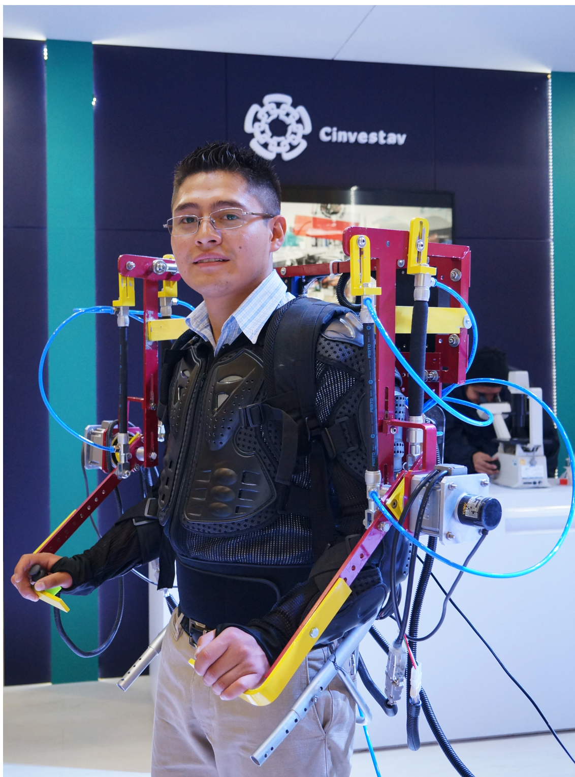
Figura 5.16: Exoesqueleto de amplificación de fuerza en la articulación del codo.
