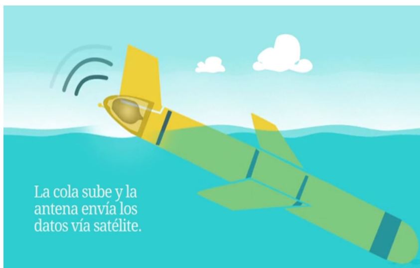
Figura 1.8: Localización de la antena de comunicación con la estación en la superficie.
