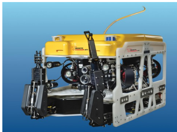
Figura 1.3: ROV, COUGAR, desarrollado por la empresa Seaeeye en Reino Unido. Capas de lograr inmersiones de hasta dos mil metros
