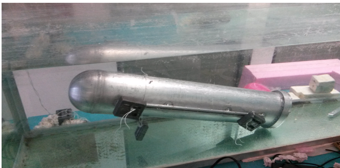
Figura 5.1: Prueba de hermeticidad del vehículo en una pecera.
