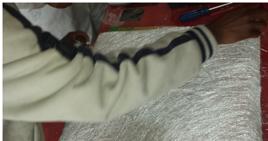
(d) Applying the Fiber glass
