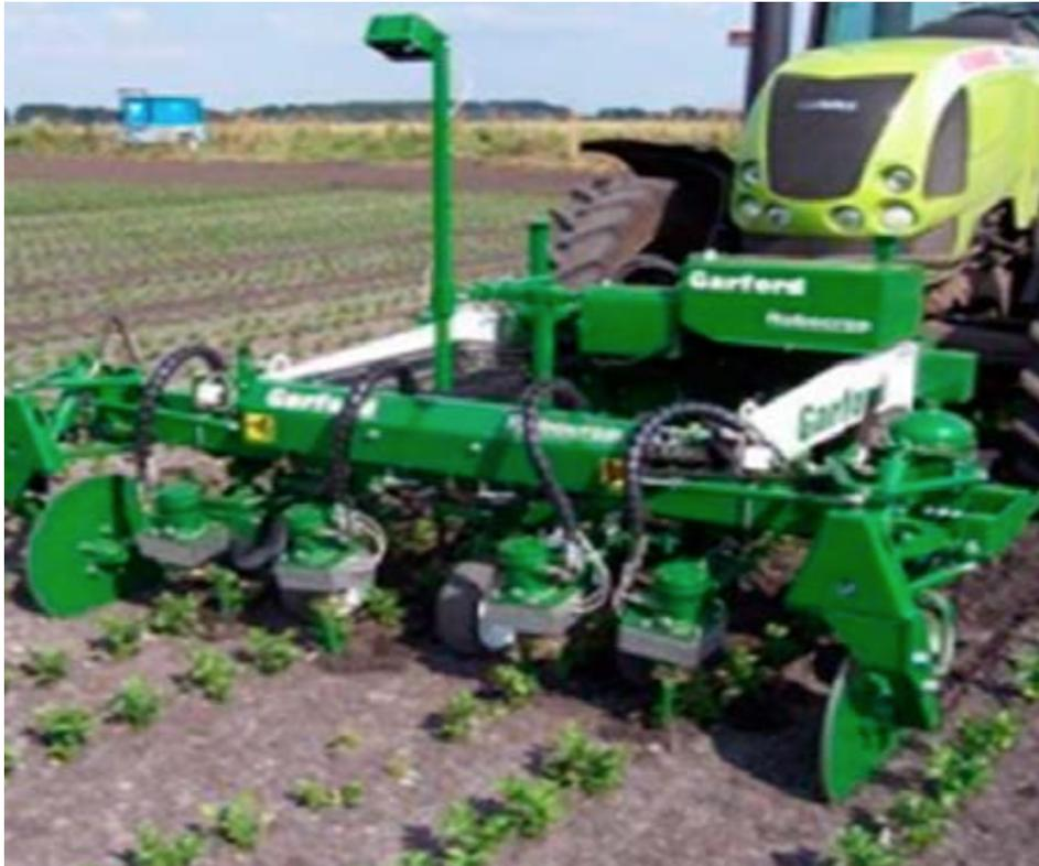
Figura 1.9: Robocrop, tractor robotizado de la empresa Tillett and Hague Technology Ltd., para eliminar la maleza de forma mecánica sin dañar el cultivo útil [18].
