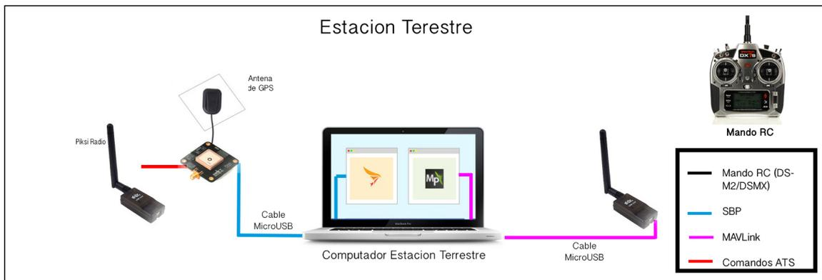
Figura 2.1: Diagrama de interacción de componentes en GCS.
