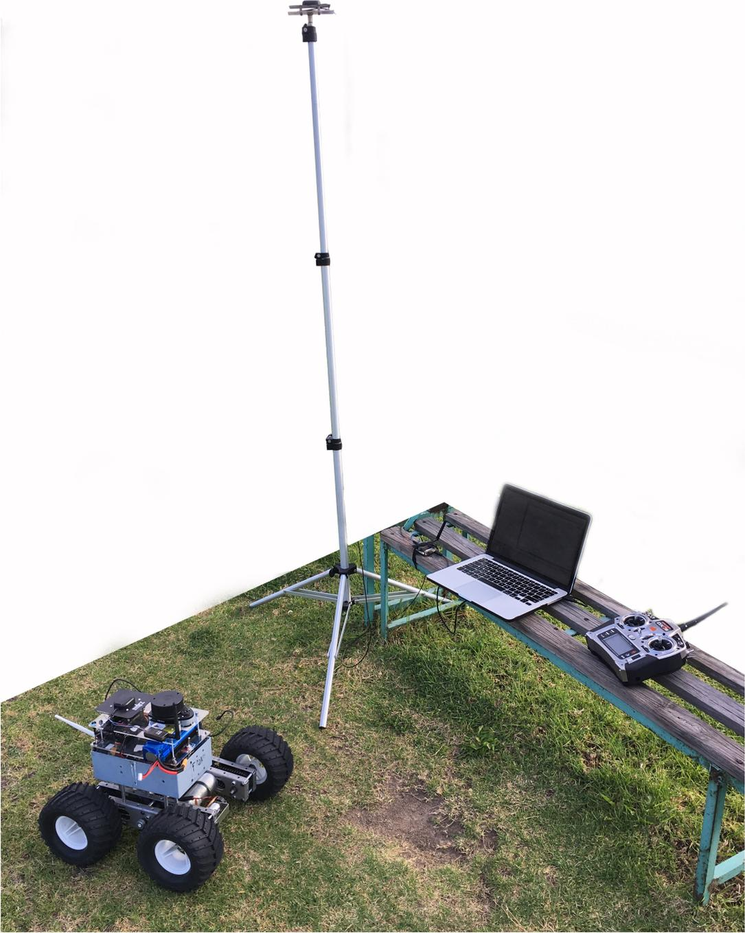
Figura 2.9: Foto de sistema RTK.
