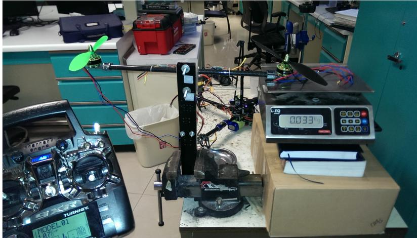
Figura B.2: Plataforma de pruebas para medir el empuje de un motor.
