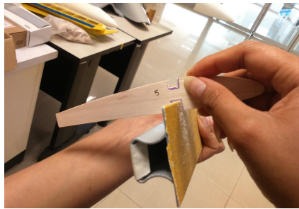
Figura 4.15: Limar recortes para vigas de soporte
