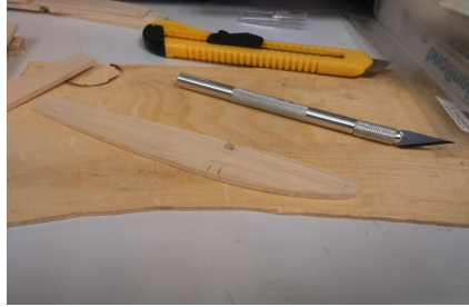
Figura 4.14: Cortes sobre balsa para vigas de soporte
