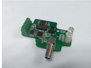
Figura 4.10: Módulo de comunicación montado en cada uno de los vehículos
