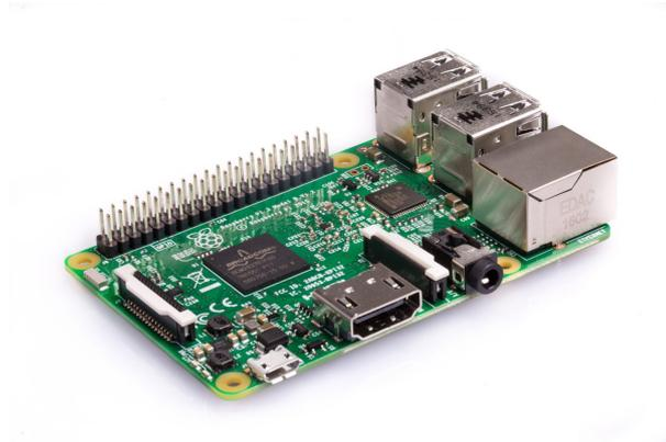
Figura 4.7: Computadora embebida Raspberry Pi 3
