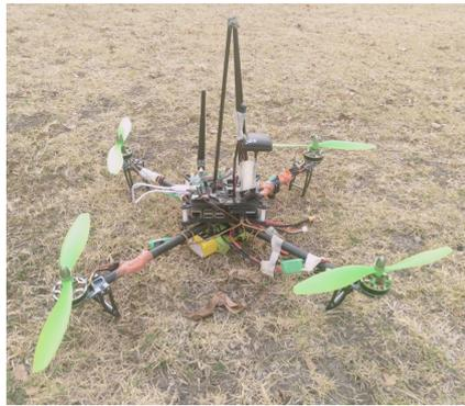
Figura 4.2: Cuadricóptero utilizado para las pruebas experimentales
