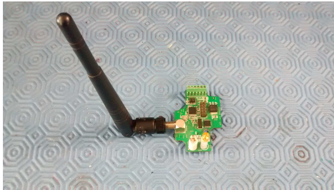
Figura 5.2: Radiotransmisor montado al cuadricóptero intruso.
