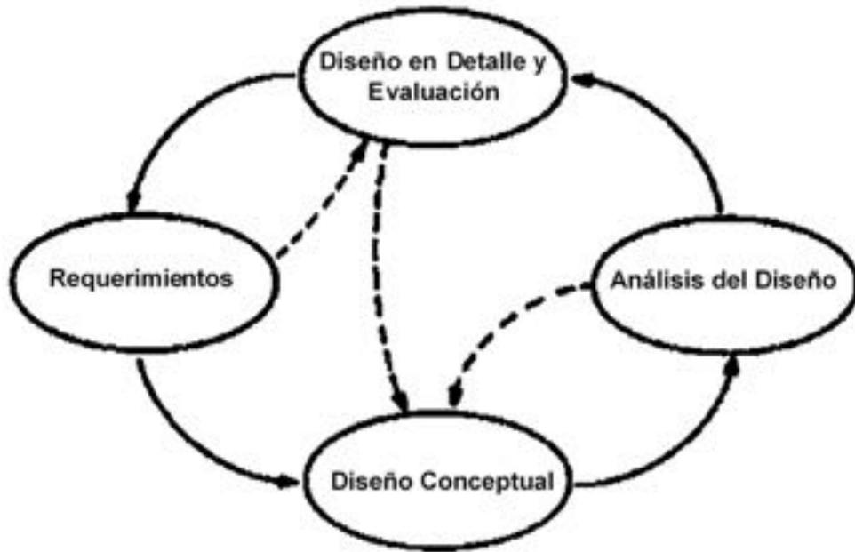
Figura 2.1: Diagrama de flujo del proceso de diseño.
