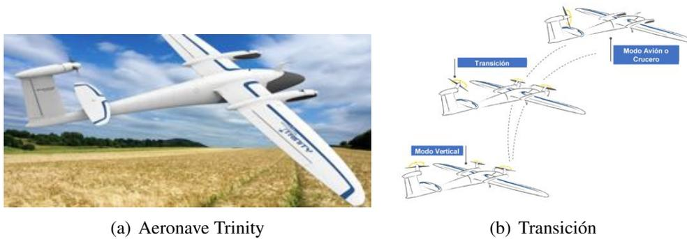
Figura 1.2: Aeronave Tilt-Rotor Trinity desarrollada por la empresa Quantum Systems
