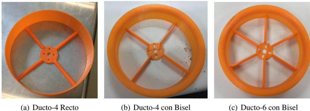
Figura 2.20: Ductos utilizados en las pruebas.
