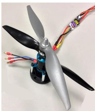
Figura 3.2: Motor Contrarotativo Himax CR2816-1100 colocado en la parte frontal del vehículo.
