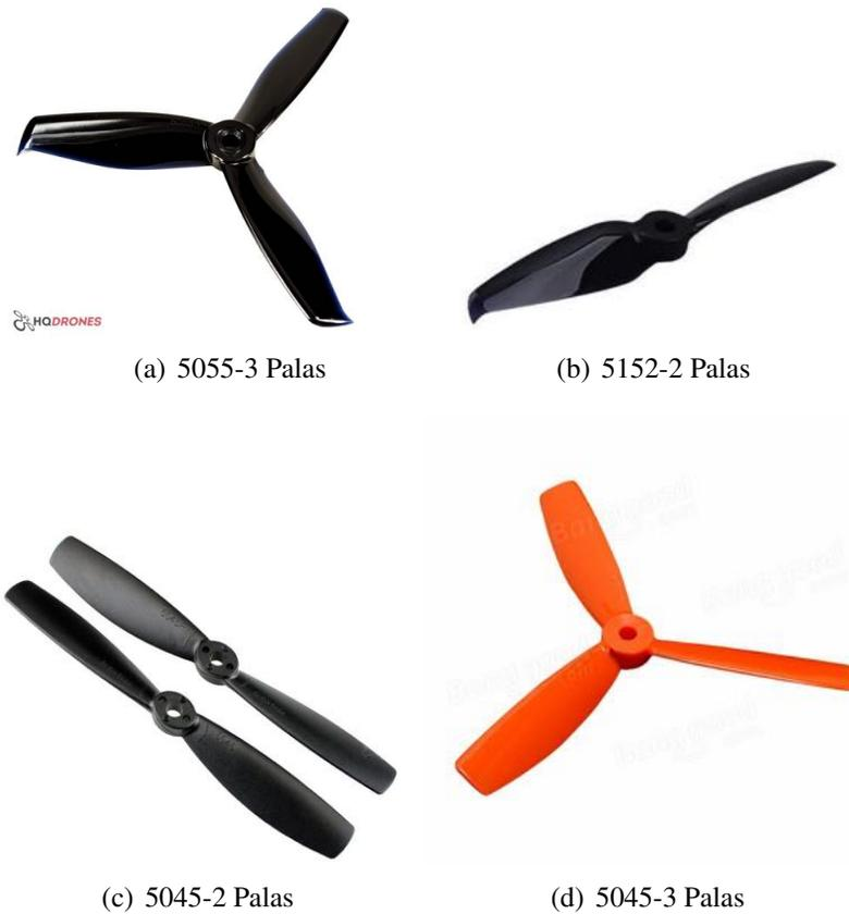
Figura 2.19: Rotores de paso fijo utilizados en las pruebas
