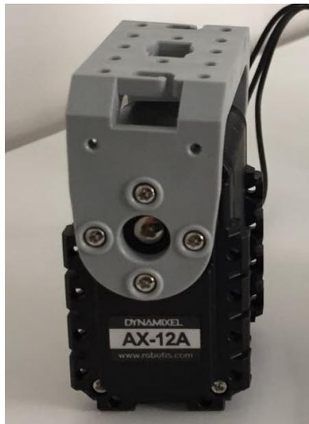
Figura 3.6: Actuador DYNAMIXEL AX-12A utilizado para hacer bascular el motor coaxial HIMAX.
