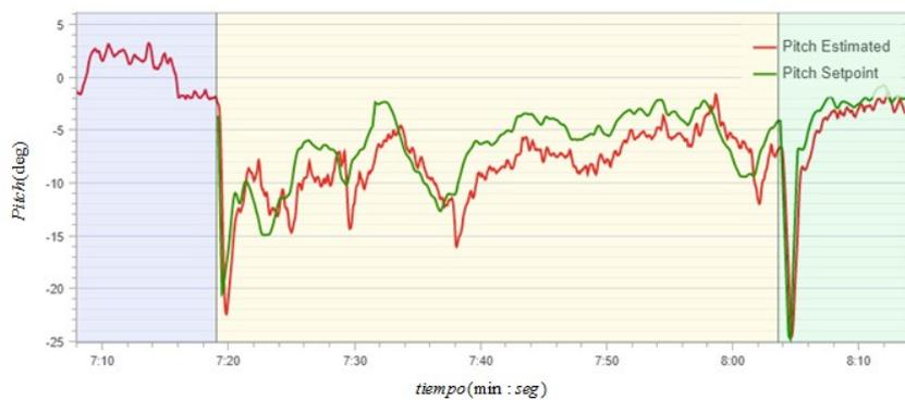
Figura 8.5: Ángulo de cabeceo de la aeronave durante el control de altura.
