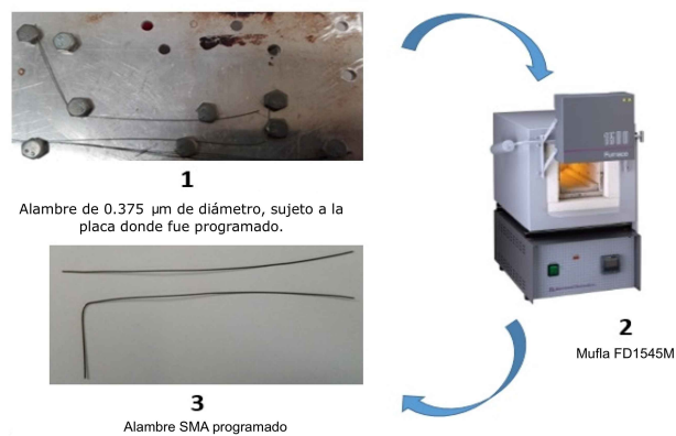
Figura 3.35: Recocido del alambre con memoria de forma
