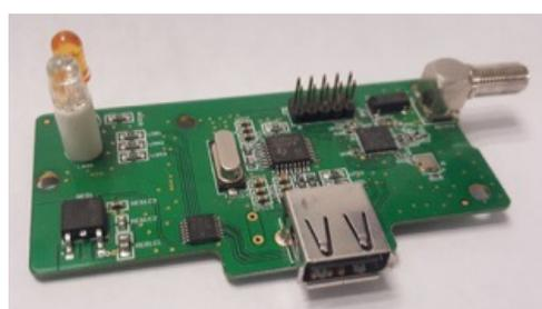
Figura 3.10: Módulo de radiofrecuencia empleado en la *GCS*
