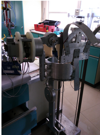
Figura 4.8: Exoesqueleto de brazo empleando para probar el ARSE
