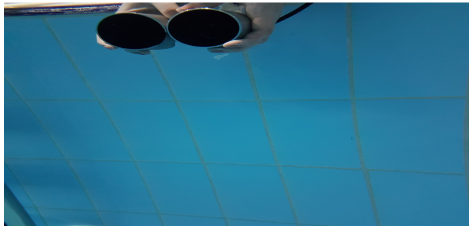
FIGURA 7.7: Transductores orientados para medir el ancho de la alberca
