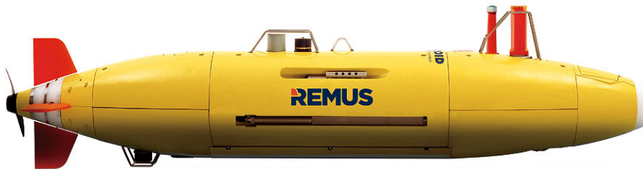
FIGURA 2.4: Vehículo REMUS 6000 desarrollado por Hydroid Fuente: www.kongsberg.com
