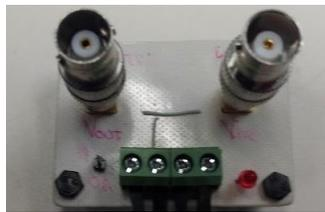
(a) Tarjeta prototipo del transmisor frente
