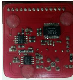
Figura 2.30: DAC de 12 bits de resolución
