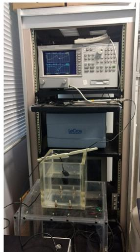
Figura 2.15: Prueba del transductor con el analizador de precisión de impedancias Agilent 4294A.
