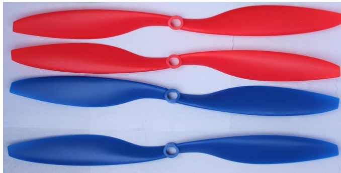
Figura 4.6: Propelas de 12x4.5" utilizadas.
