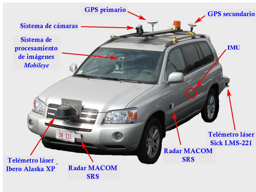
Figura 2.1: Vehículo terrestre con todos los sistemas y sensores utilizados para su navegación autónoma [31].
