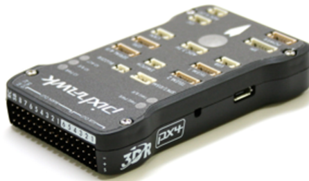
Figura 3.3: Controlador de vuelo Pixhawk 1 manufacturado por 3DR.
