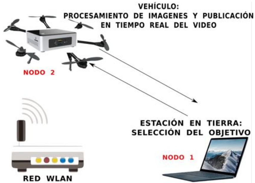
Figura 3.4: Diagrama de comunicación del sistema completo.
