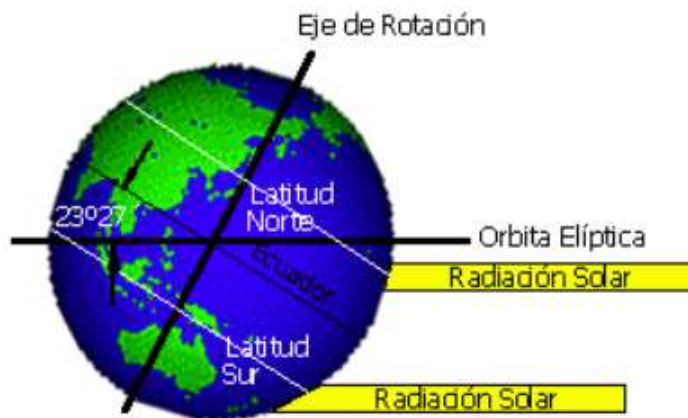
Figura 3.1: Variación de radiación por la latitud.
