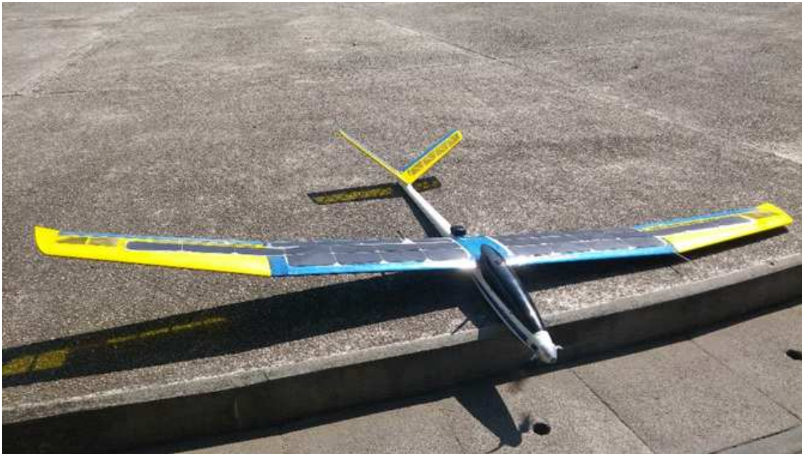
Figura 3.17: Planeador solar finalizado.
