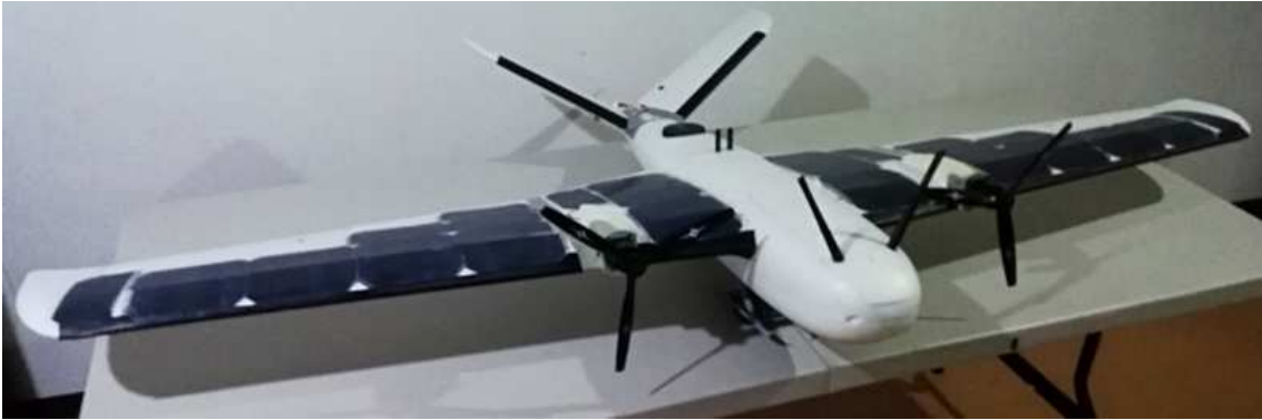
Figura 3.21: Prototipo solar dos con la adaptación del sistema PV.
