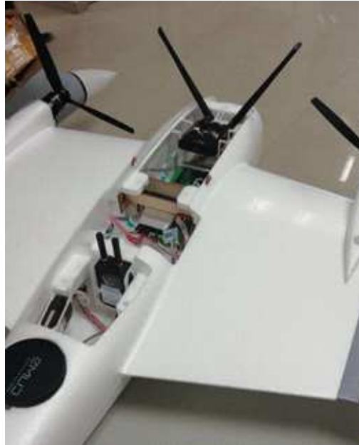
Figura 2.17: Acomodo de la electrónica y autopiloto en el prototipo dos.
