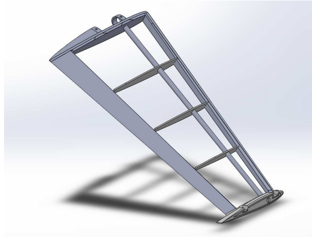
Figura 2.11: Diseño estructural del estabilizador izquierdo de la cola en V.
