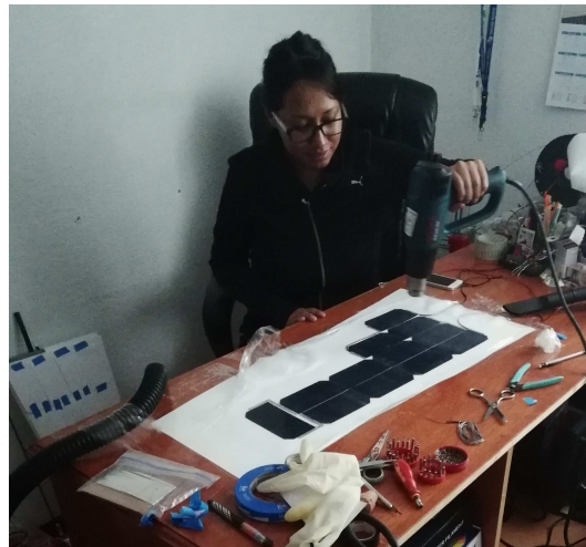
Figura 3.20: Encapsulación de uno de los cuatro paneles solares del prototipo dos.
