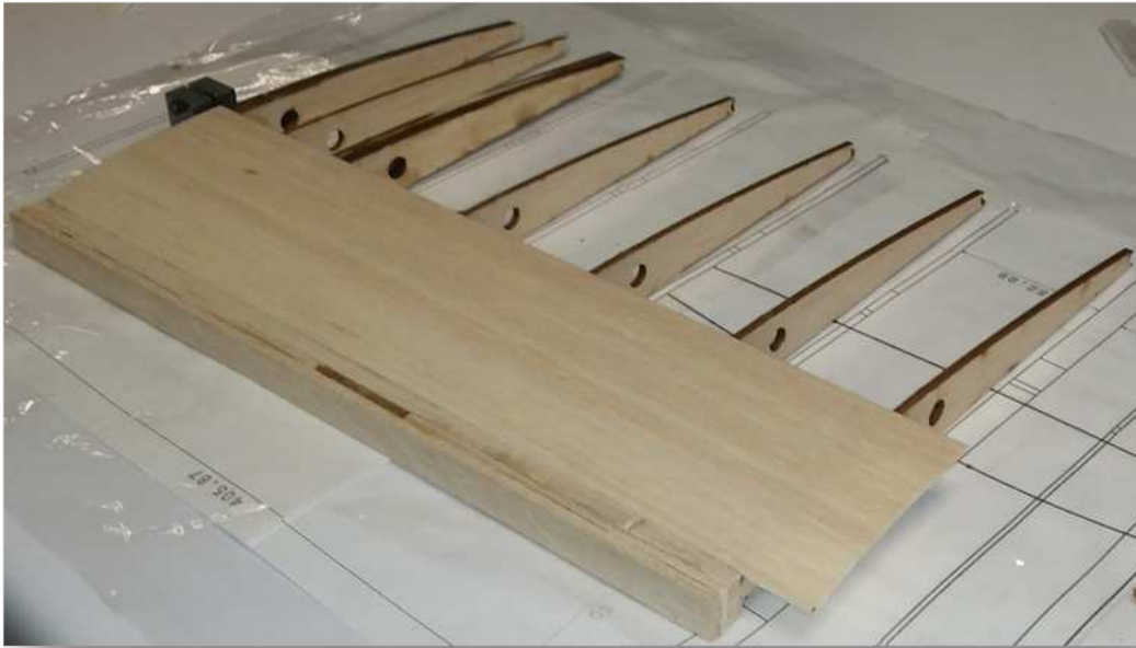
Figura 3.3: Sección del ala en proceso de construcción.
