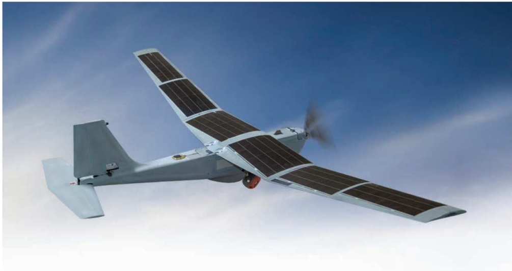
Figura 1.10: UAV PUMA AE con celdas solares de Thin GaAs.
