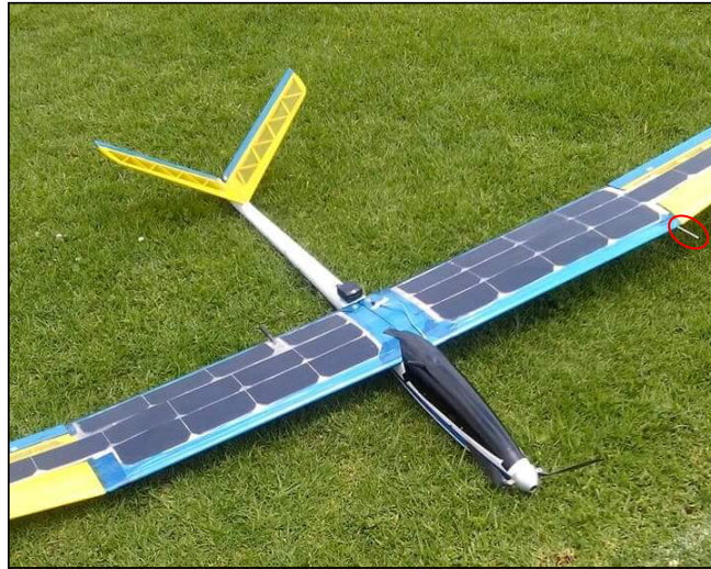
Figura 5.1: SUAV en el campo de vuelo, realizando una revisión pre-vuelo. El tubo pitot está marcado en rojo.
