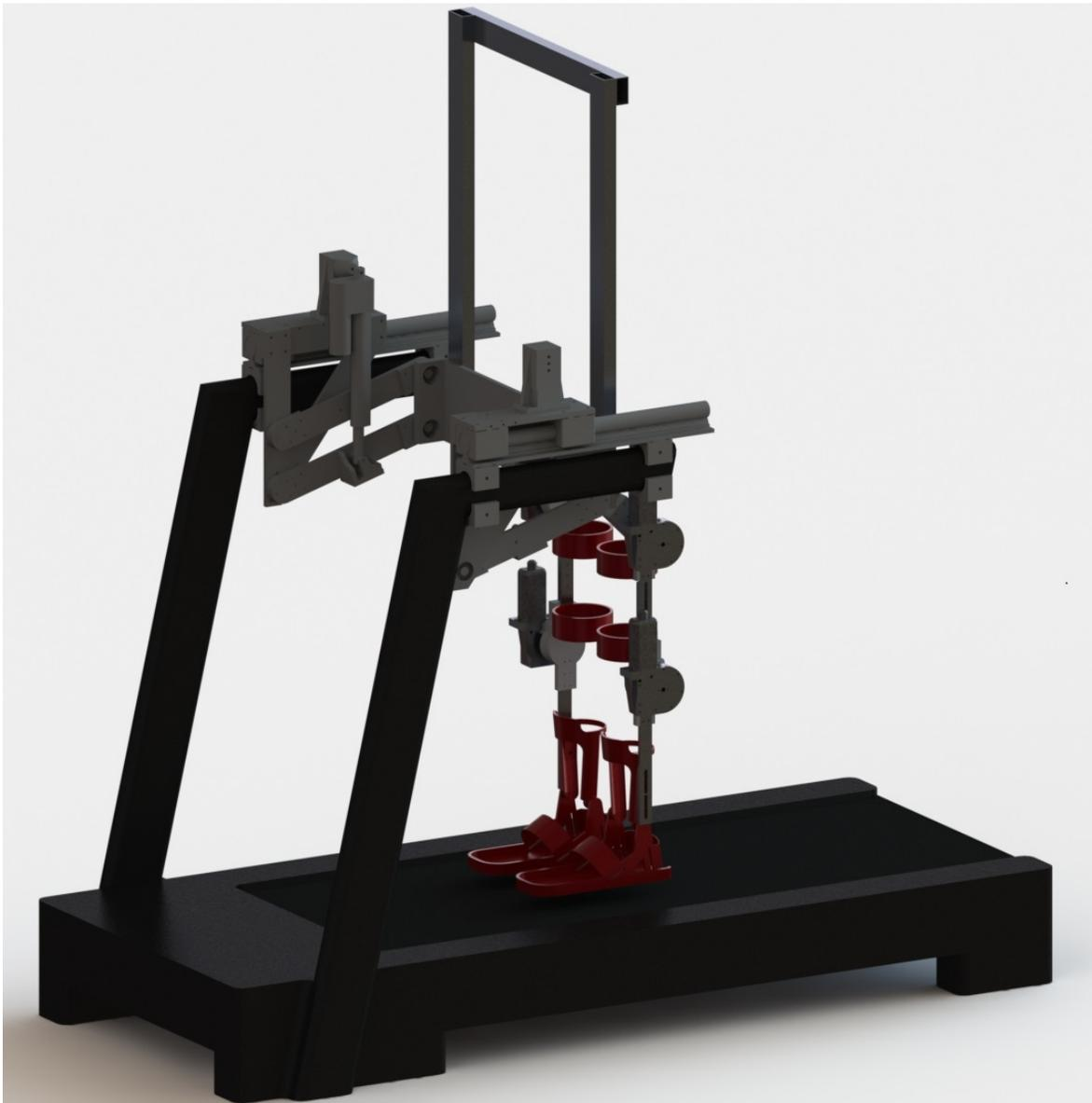
Figura 4.14: Diseño en CAD del exoesqueleto completo; vista isométrica
