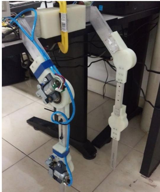
Figura 4.23: Piernas mecánicas en proceso de construcción.
