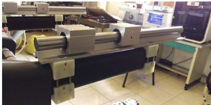
Figura 4.22: Montaje de la base del sistema de levantamiento.
