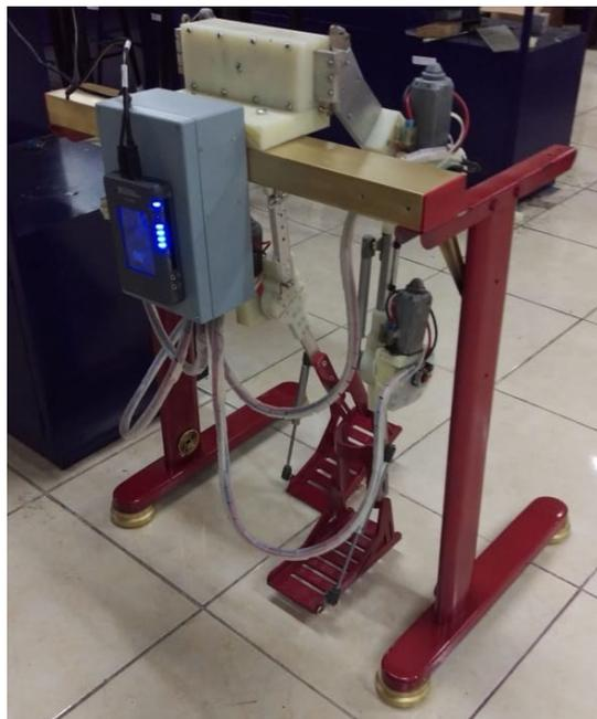
Figura 4.24: Piernas mecánicas terminadas, base provisional.
