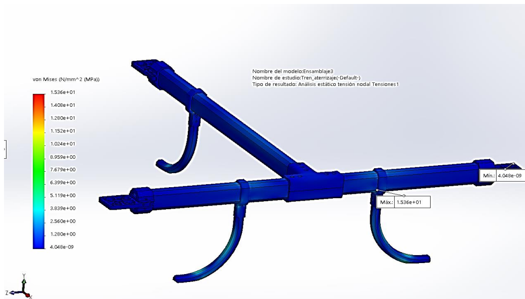
(a) Esfuerzo máximo equivalente a 15.36 MPa
