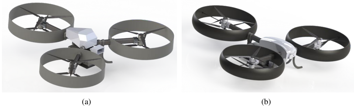
Figura 3.19: Implementación de protectores de motores en el área del sistema de propulsión.
