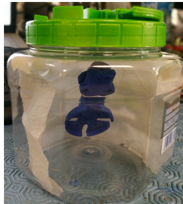
Figura C.2: Pieza con tratamiento. a) Baño de acetona. b) Pieza final
