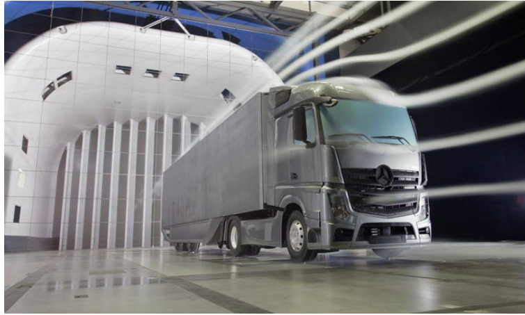
Figura 1.6: Prueba de túnel de viento en camión Mercedes-Benz [15]
