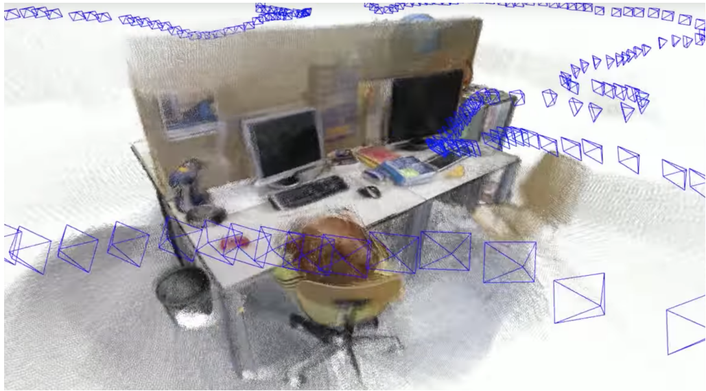
Figura 3.10: Ejemplo de reconstrucción semi-densa. Se puede apreciar la secuencia de keyframes indicando la trayectoria de la cámara [?].
