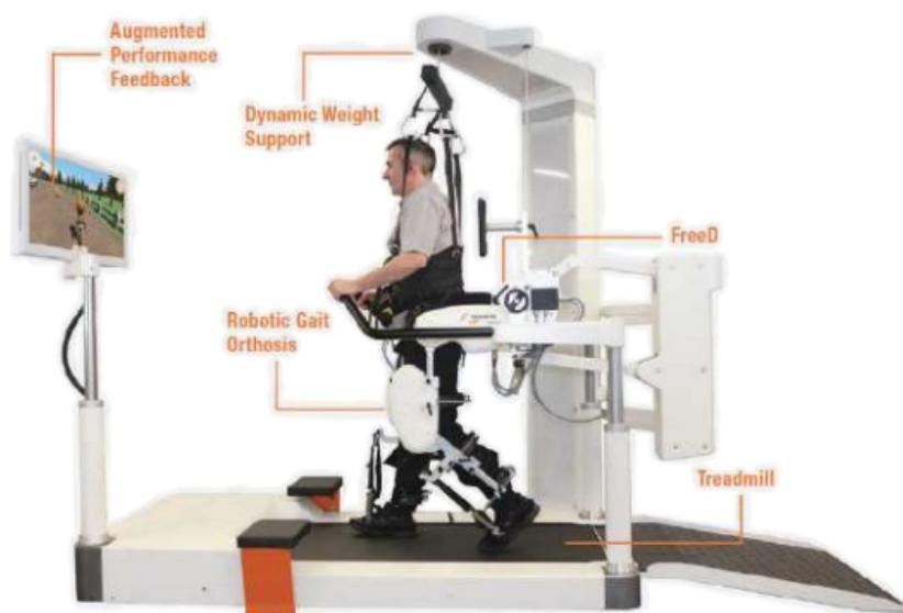
Figura 1.11: Exoesqueleto LokomatPro.
