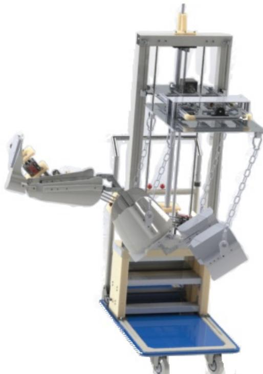
Figura 3.18: Órtesis HKAFO montada en el mecanismo XYZ
