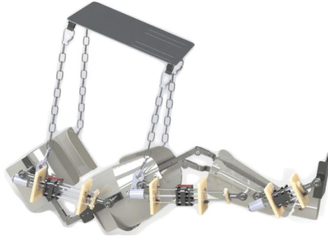
Figura 3.17: Órtesis HKAFO con actuadores
