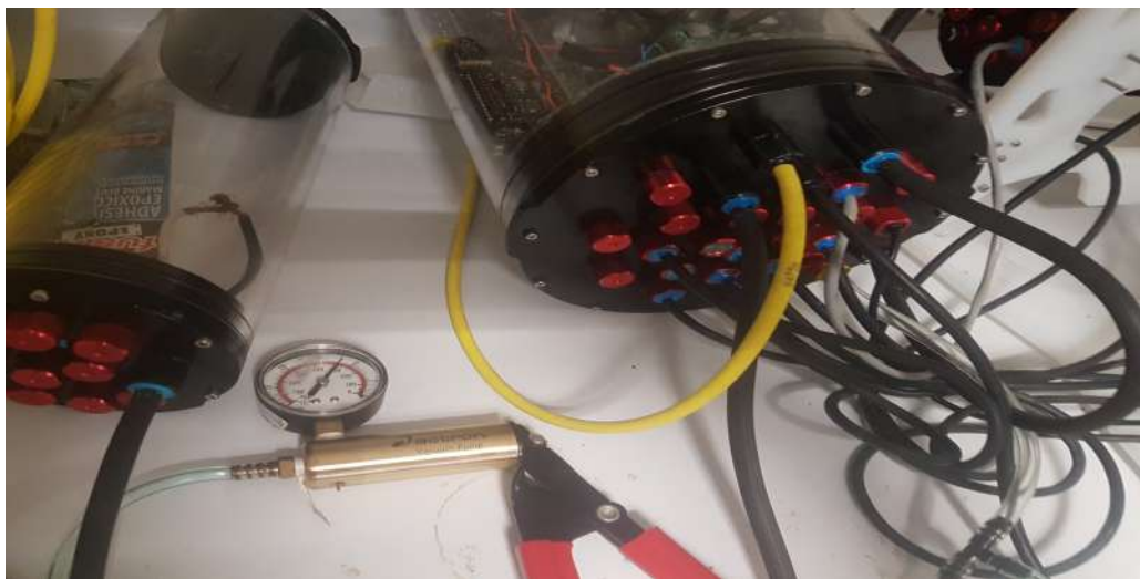
Figura 3.27: Indicador de carátula para la pruebas de vacío Octosub
