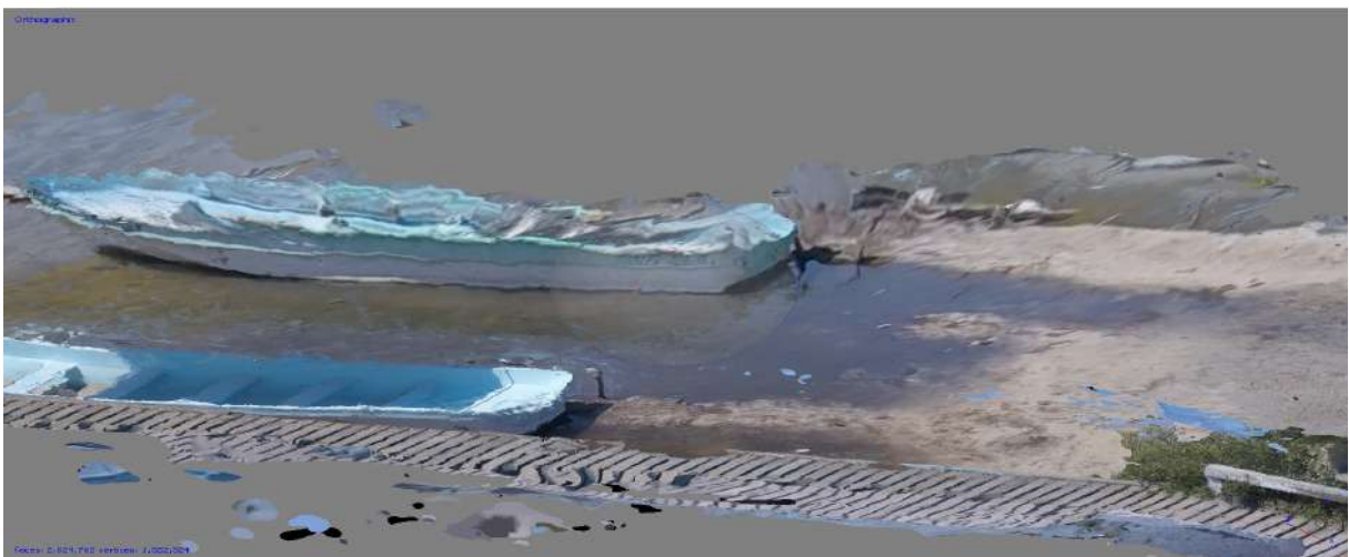
Figura 4.11: Reconstrucción del puerto Chelen usando los fotogramas de un vídeo.
