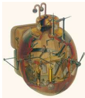
Figura 1.2: Submarino Turtle (Tortuga). Primer submarino militar (1775) diseñado por David Bushnell, utilizado en la guerra de independencia de los Estados Unidos.
