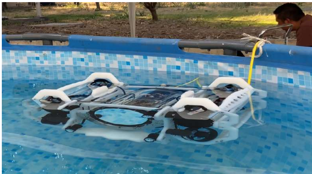
Figura 3.33: Compensación de la flotabilidad en el OctoSub, dejando una ligera flotabilidad positiva.
