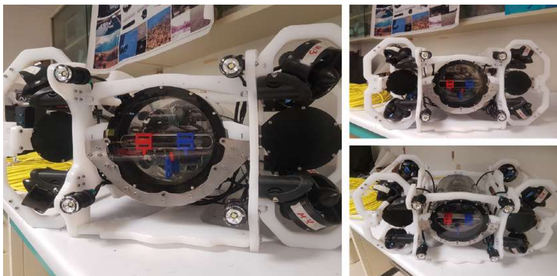
Figura 3.26: El armado final del Octosub se muestra en estas figuras, donde todos los subsistemas se encuentra incluido.
