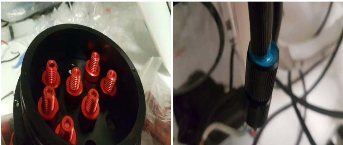
(a) Distribución de los conectores en las tapas del vehículo submarino. (b) encapsulado de los conectores de los motores y cables de alimentación.
