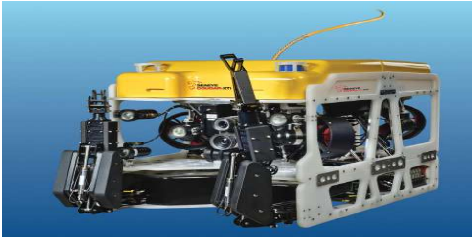
Figura 3.1: ROV, COUGAR, desarrollado por la empresa Seaeve en Reino Unido. Capaz de lograr inmersiones de hasta dos mil metros
