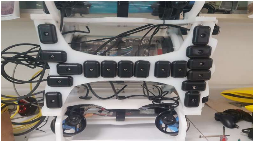
Figura 3.32: Equilibrio de los pesos para sumergir el OctoSub de manera uniforme.
