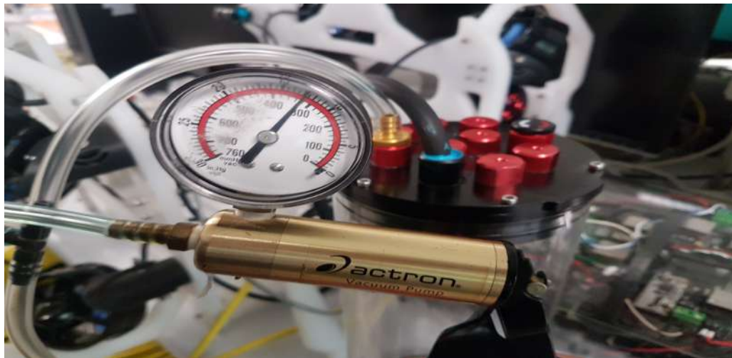
Figura 3.28: Pruebas de vacío Octosub
