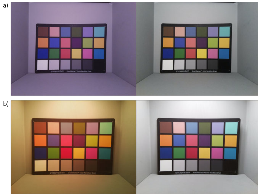
Figura B.3. Balance de blancos en Cámara Raspberry Pi V2. a) Imágenes capturadas con AWB provocando un decremento en la temperatura del color, es decir, un aumento en la tonalidad de azules; b) Imágenes capturadas con AWB provocando un aumento en la temperatura del color, por tanto, existe un aumento en la tonalidad de rojos. Imágenes obtenidas de [37]
