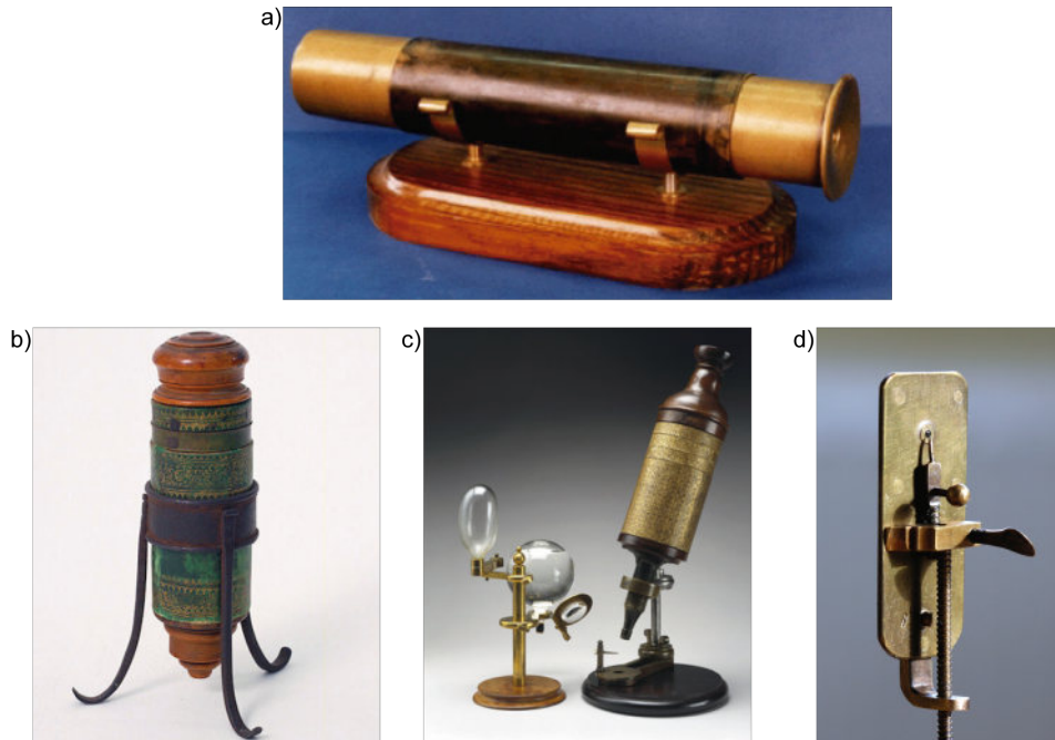
Figura 1. Inicios de la microscopía. a) Primer microscopio compuesto que se atribuye a Jansen. b) El microscopio de Galileo Galilei. c) Microscopio compuesto de Hooke, con él se realizó la primera observación de células. d) Microscopio de Leeuwenhoek, con él se realizaron las primeras observaciones de microorganismos. Imágenes obtenidas de [4, 5, 6, 7]
