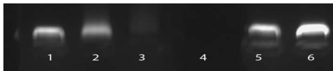
Figura 1.7: Electroforesis en gel de muestras de ADN expuestas a radiación bajo las siguientes condiciones: 1) control; 2) 40 min de UV simultáneamente con 40 min de luz verde; 3) 40 min de UV; 4) 50 min de UV; 5) 50 min de UV simultáneamente con 50 min de luz verde; 6) 50 min de luz verde [21].
