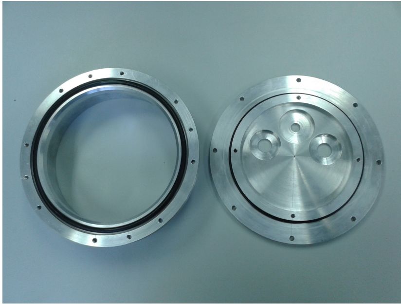
Figura 5.9: Tapa y brida manufacturados en aluminio, se pueden notar los sellos de nitrilo.
