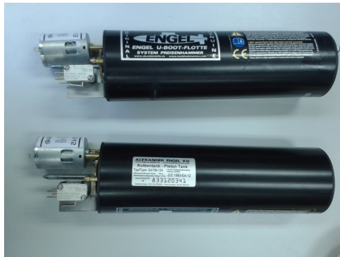
Figura 5.12: Tanque de lastre que se utilizó, con capacidad para diez metros de profundidad.
